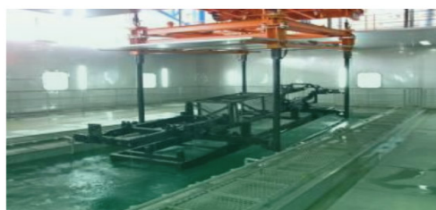
Vollständige kathodische Elektrotackierung
